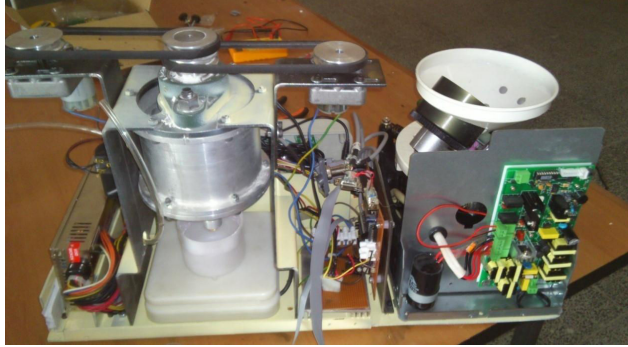
Şekil 6. Şase montaj katı modellemesi(a), üretimi yapılmış ve montaj edilmiş şase elemanları
