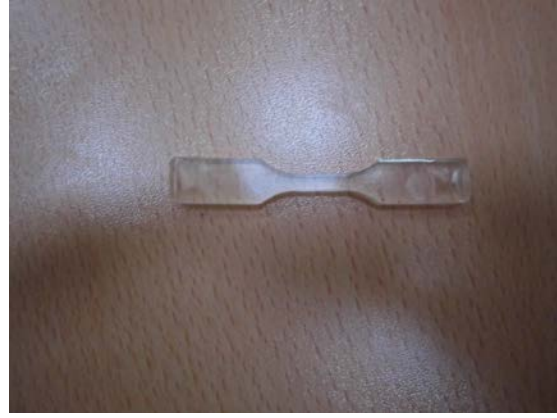
Şekil 2. AISI H11 sıcak iş takım çeliğinden edilen çekme deneyinde kullanılacak PVC numunesi
