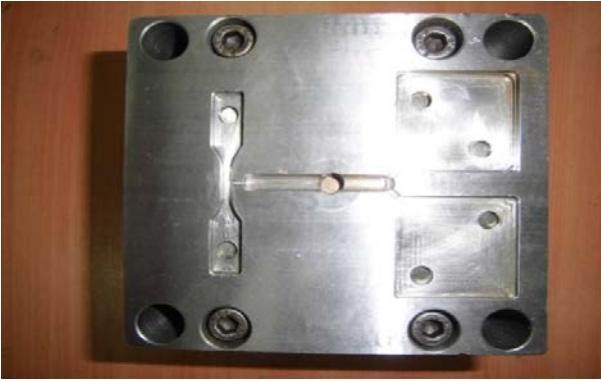
Şekil 11. PC enjeksiyonu sonrasında AISI H11 sıcak iş takım çeliğinde oluşan korozyon
