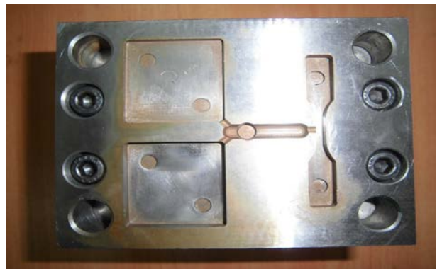
Şekil 9. PC enjeksiyonu sonrasında AISI Ç1040 karbon çeliğinde oluşan korozyon
