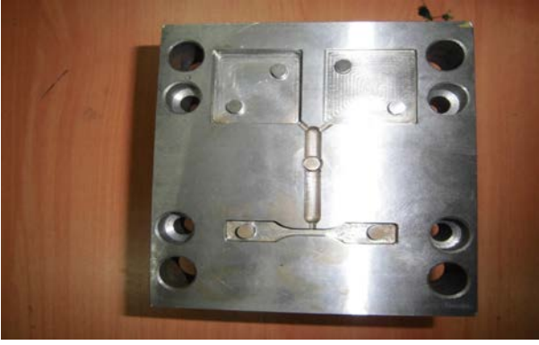
Şekil 10. PC enjeksiyonu sonrasında AISI P20 plastik kalıp takım çeliğinde oluşan korozyon
