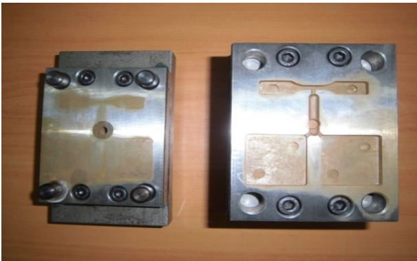
Şekil 5. PVC enjeksiyonu sonrasında AISI Ç1040 karbon çeliğinde oluşan korozyon
