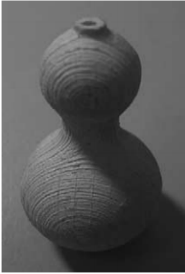
Şekil 8 LOM yöntemi ile üretilen parça
