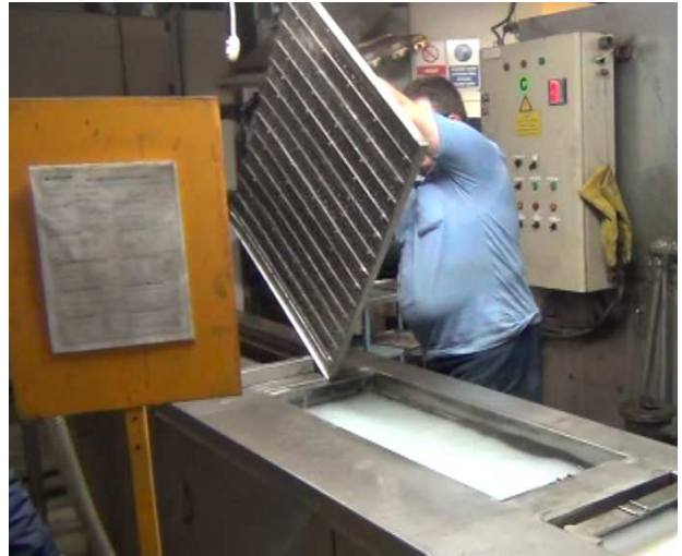
Şekil 6. Valf plakası ultrasonik banyoda yıkama istasyonu
