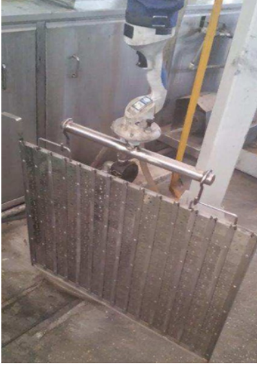
Şekil 7. İyileştirme sonrası valf plakası ultrasonik banyoda yıkama istasyonu
