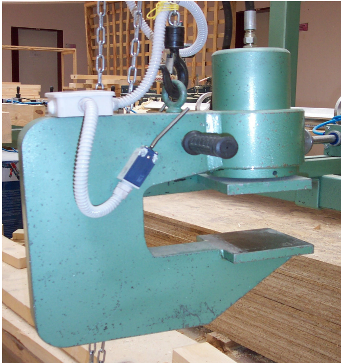
Şekil 2. Birleştirmelerin hazırlanmasında kullanılan C tipi pres.
