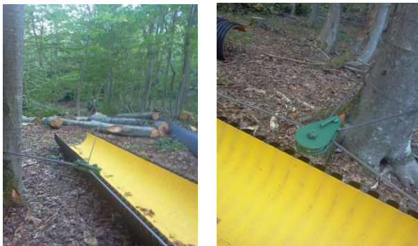
Şekil 5. Tomrukları oluk güzergâhına kadar çeken makara sistemi
