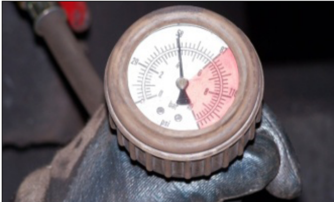
Şekil 4. Basınç ölçümünde kullanılan manometre (Dağdelen vd. 2009)
