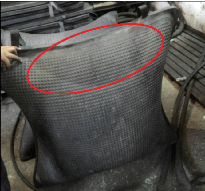
Şekil 15. Hava yastıklarında meydana gelen balonlaşma arızası
