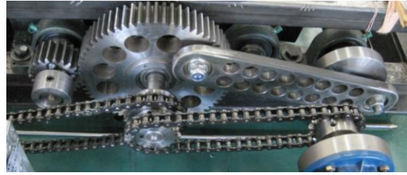
Şekil 10. Tahrik mekanizması sabit montaj durumu (sağ taraf)
