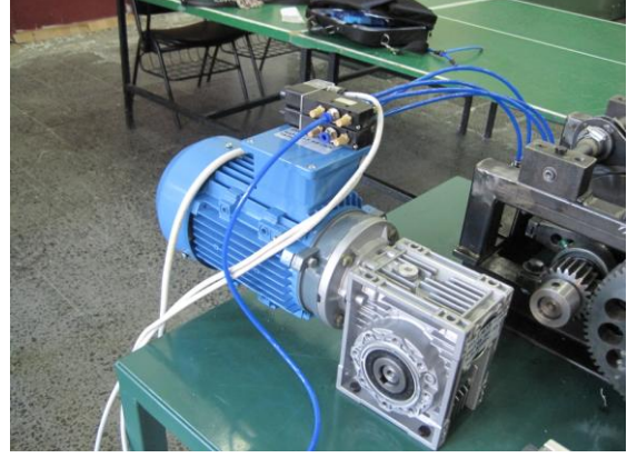
Şekil 9. Motor ve redüktörün montaj durumu
