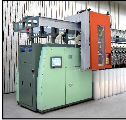
Şekil 9. 100 eğirme ünitesi ve 4 robotlu J 10 hava-jetli iplik makinesi ve iplik oluşumu ( http://www.rieter.com/en/spun-yarn-systems/products/air-jet-spinning/j-10-air-jet-spinning-machine/ )
