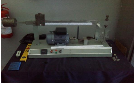
Şekil 3. Yorulma test cihazı (Çelik, 1995)
