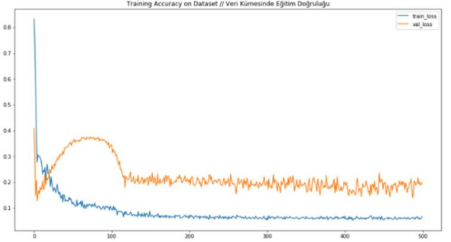
Şekil 13. 6 katmanlı ve 500 epoch modelin veri kümesi eğitim doğruluğu
