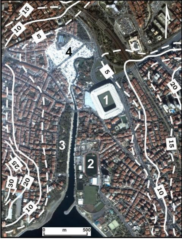
Şekil 9. Fenerbahçe Şükrü Saraçoğlu Stadyumu, Kurbalidere vadisi alüvyal dolgusu üzerinde kurulmuştur (2007). Stadyum çevresi son 50 yıllık dönemde tarım alanlarından yerleşme alanlarına doğru hızlı bir değişim gözlenmiştir. (1-Fenerbahçe Şükrü Saraçoğlu Stadyumu, 2-Dereağzı spor tesisleri, 3-Yoğurtçu parkı, 4-Salıpazarı).
