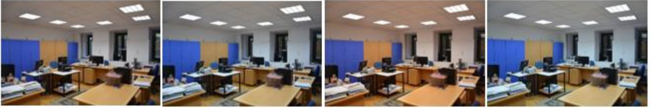
AS1 s : 500lx, 4000 K AS2 s , AS5 d (5): 1000 lx, 5500 K AS3 s : 1250 lx, 4000 K AS4 s : 1500 lx, 5500 K
