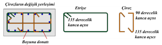
Şekil 12. Etriye ve çirozların gösterimi.
