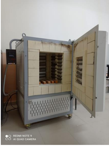
Görsel 11. Pişirme işleminde kullanılan fırın.
