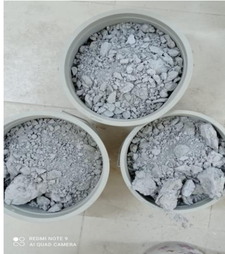
Görsel 4. Kırşehir Granitaş tesislerinden edinilen granit tozu
