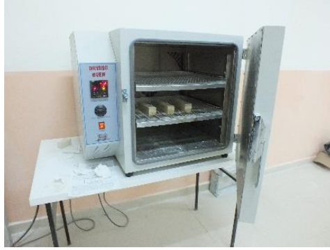
Görsel 10. Kurutma işleminde kullanılan etüv
