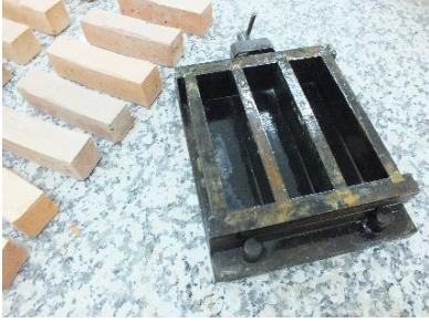
Görsel 8. Şekillendirmede kullanılan kalıp
