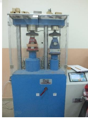
GörSEL 13. Basınç ve eğilme dayanımı testlerinde kullanılan pres
