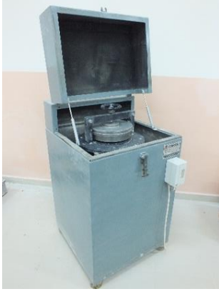
Görsel 5. Malzeme öğütmede kullanılan halkalı değirmen
