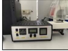
Şekil 2. Permetest ölçüm cihazı
