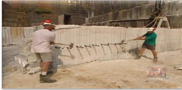
Şekil 5 Delme çatlatma yönteminde deliklerin çatlatılması-Alt kesim [10]
