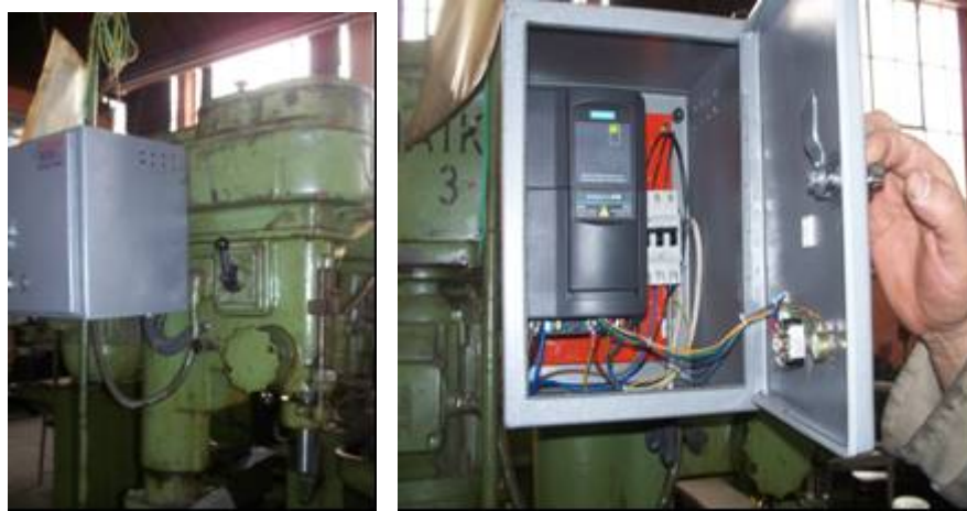
Şekil 8. Matkap tezgâhlarına takılan sürücü sistemi
