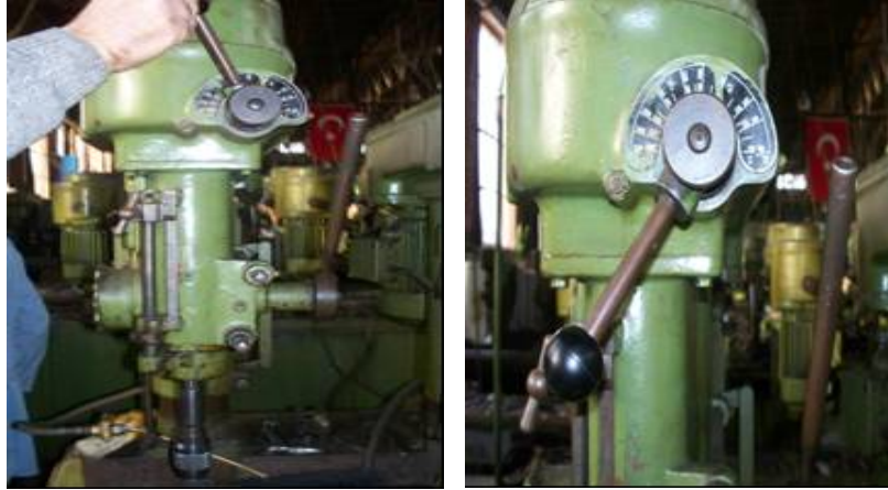
Şekil 3. Matkap tezgâhlarında uygulama öncesi devir ayar sistemi
