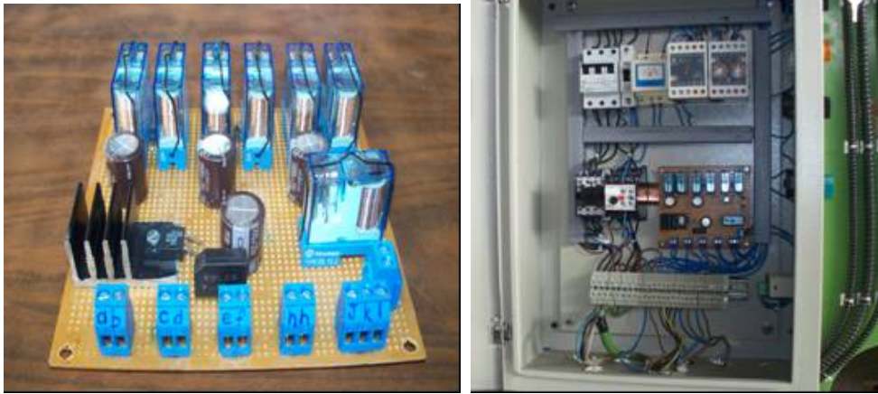
Şekil 7. Pres tezgâhlarına takılan emniyet sistem parçalarının ayrı ve montaj edilmiş görüntüleri
