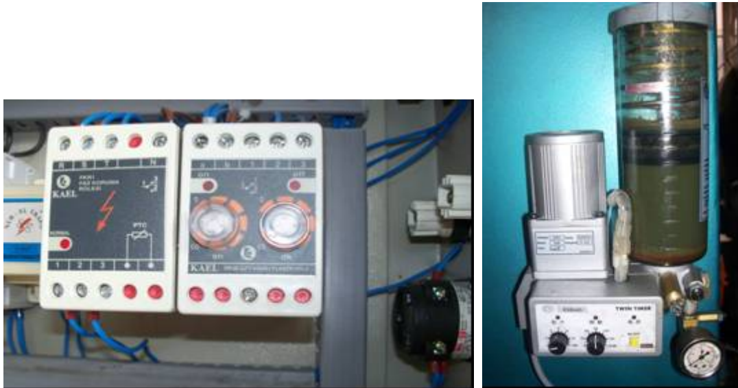
Şekil 4. Pres tezgâhlarına monte edilen zaman rölesi ve otomatik yağlama pompası
