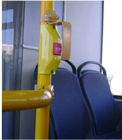
Şekil 1. Üzerine koruma aparatı monte edilmiş duracak düğmesi
