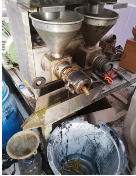
Şekil 2. Ketencik tohumlarından vidalı preste yağ elde edilmesi
