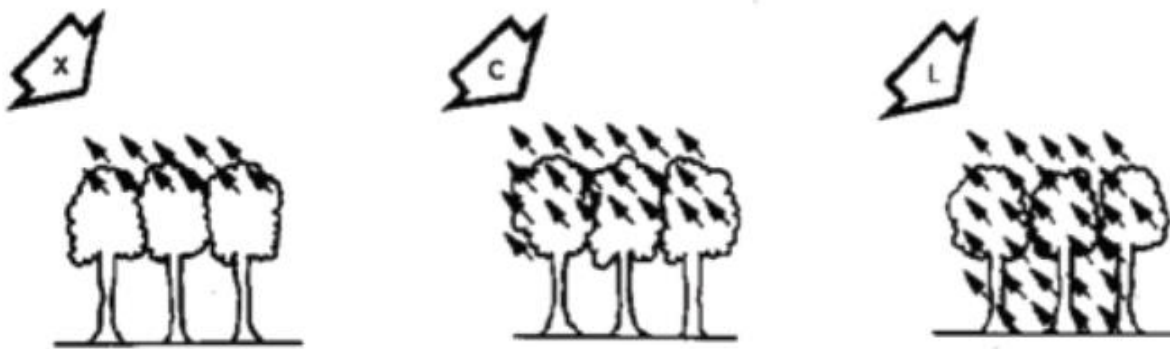
Şekil 2. Ağaçlarda radar saçılmaları (Meyer, 2019)
