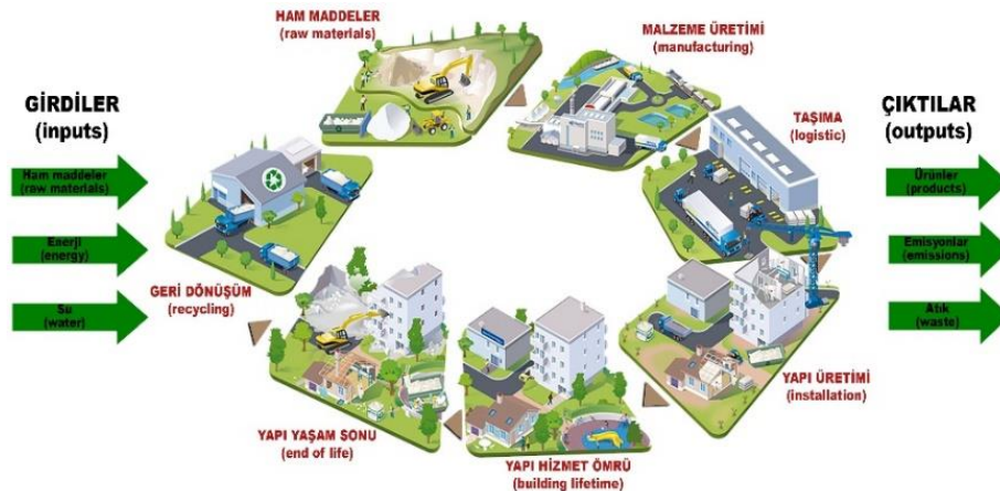
Görsel 2. Yapı üretiminde yaşam döngüsü değerlendirme (LCA) süreci (Bruce-Hyrkäs, 2021).
