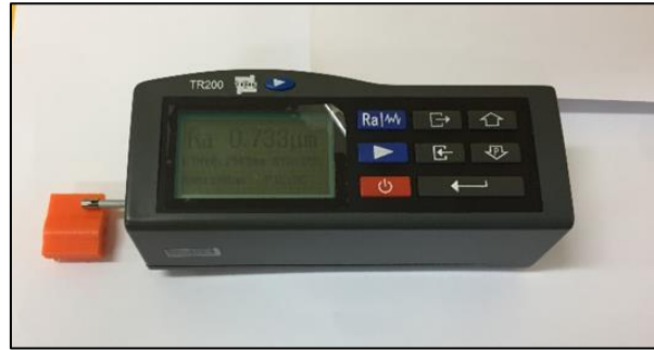
Şekil 6. Parça üzerinden yüzey pürüzlüğü ölçümü.
