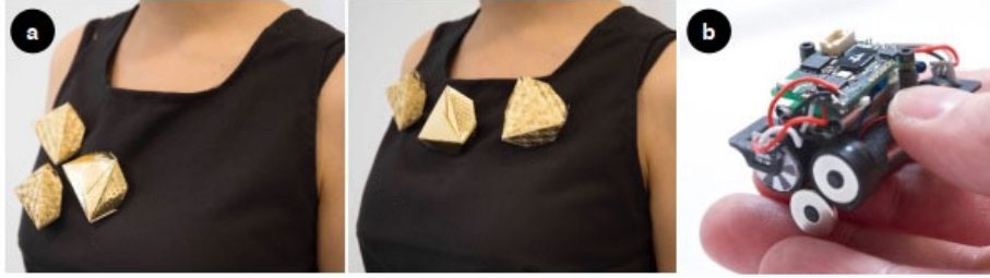
Görsel 10. Broştan kolyeye geçiş yapan kinetik giyilebilir ürün örneği (b) kılıfsız robot
