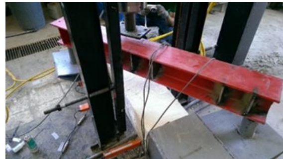
Şekil 4. Deney düzeneğine yerleştirilen kiriş numunesi
