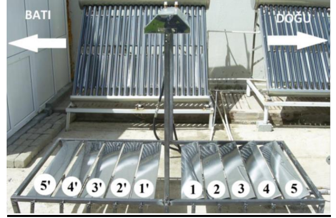
Şekil 6. Doğrusal Fresnel kolektörde aynaların yerleşimi
