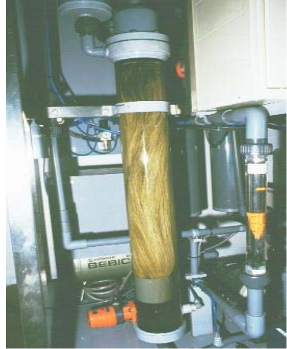
Şekil 3. Fitoplankton konsantre makinası
