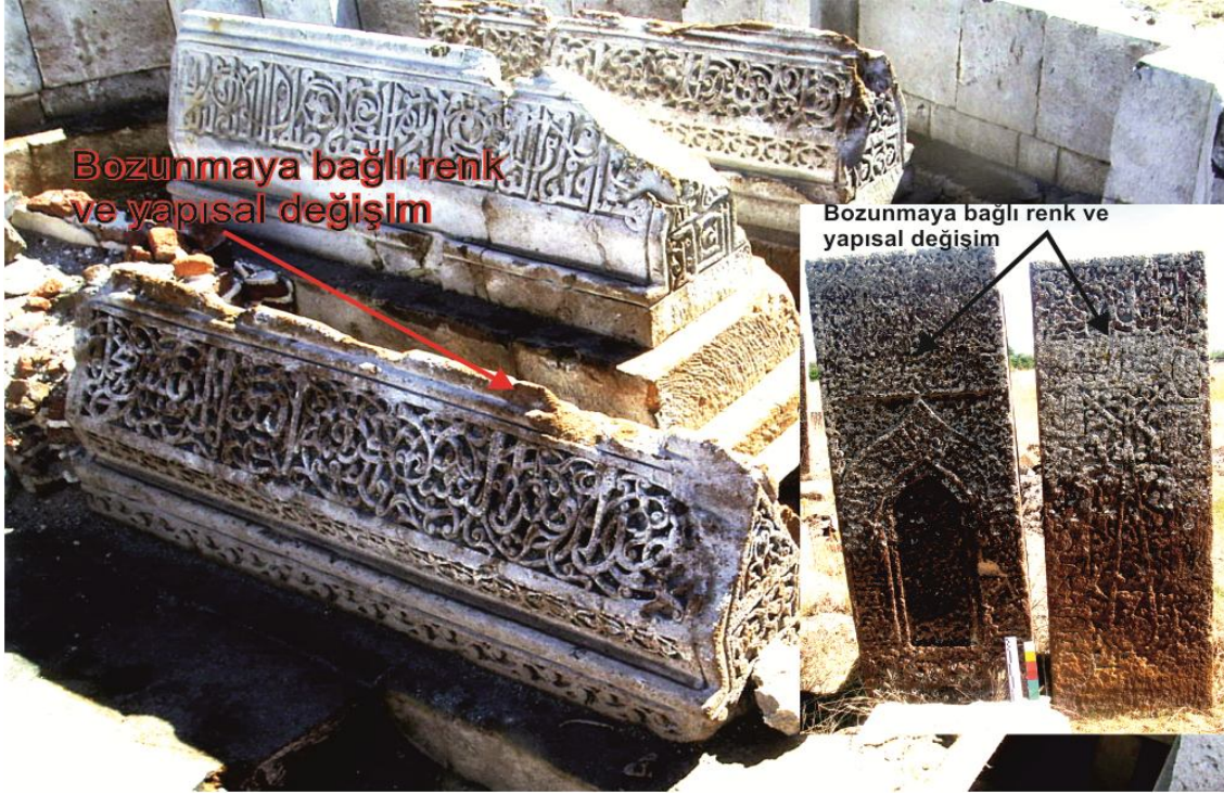
Şekil 1. Su ve nem etkisi ile Ahlat taşında (İgnimbirit) oluşan bozunmanın genel görünümü.
