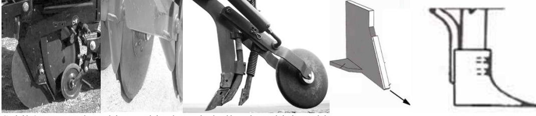
Şekil 3. Doğrudan ekim makinalarında kullanılan ekici ayaklar
