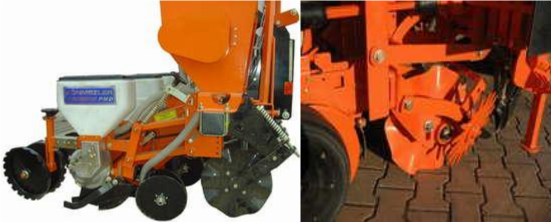
Şekil 8. F firması tarafından hassas ekim makinalarında kullanılmak üzere imal edilen çizi açıcı ve temizleyicisi üniteleri
