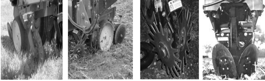
Şekil 2. Doğrudan ekim makinelerinde kullanılan kesici disk ve çizi temizleme üniteleri
