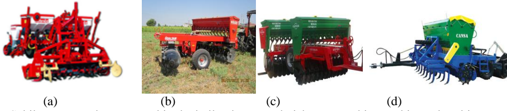
Şekil 7. Doğrudan anıza ekimde kullanılan toprak işleme ve ekim makinası kombinasyonu tipleri (a:rotorvator-hassas ekim makinası, b:diskli tırmık-ekim makinası c:diskli tırmık-ekim makinası d:çizel-ekim makinası)
