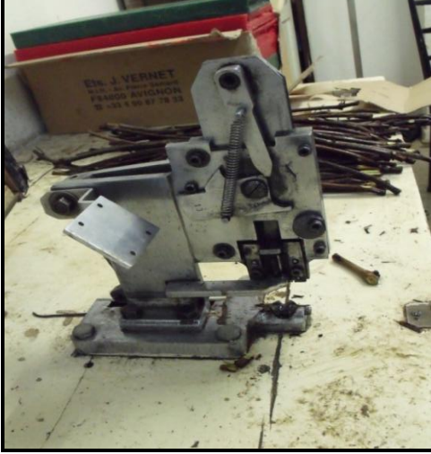
Şekil 1. Omega tipi aşı kesiti açan ayak pedallı aşı makinası
