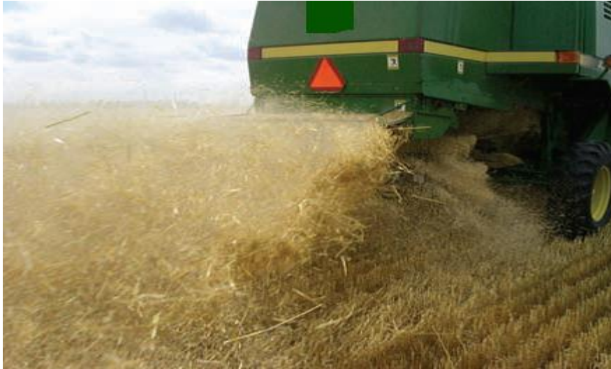
Şekil 1. Biçerdövere monte edilen sap parçalama ünitesi
