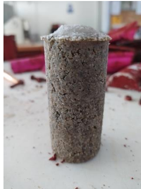
Şekil 5. Bentonitsiz referans numunelerinde karşılaşılan donma kabarması problemi
