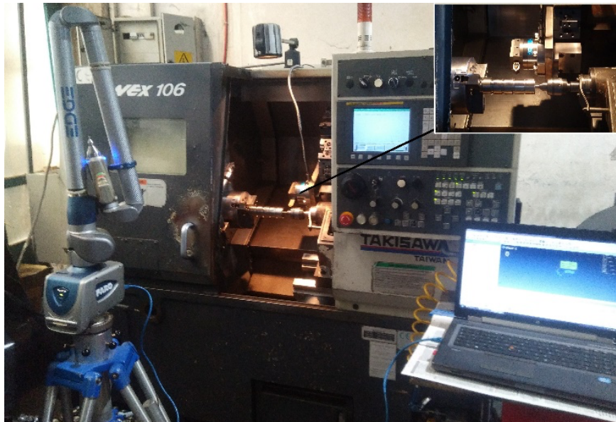
Şekil 1. CNC torna genel görünüm ve taşınabilir ölçüm kolu (CNC lathe overview and portable measuring arm)
