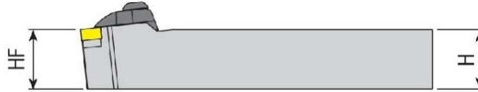
Şekil 3. Kesici takım kısım ve yükseklikleri [9] (Cutting tool parts and heights)
