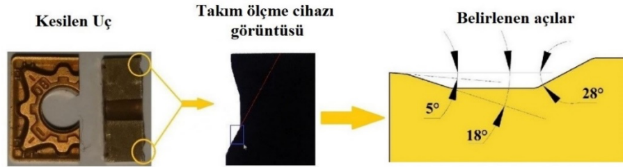
Şekil 5. Kesici uç form açıları (Angles depending on the cutter cross section and form)
