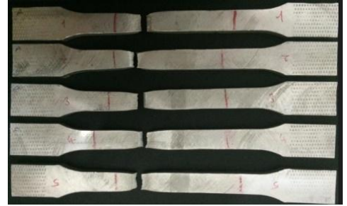
Şekil 7. Çekme deney sonrası B tipi numunelerinin görüntüleri
