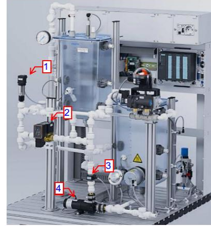
Şekil 1. MPS-PA Compact Workstation Deney seti; 1) Basınç sensörü, 2) Oransal vana, 3) Akış sensörü, 4) Pompa motoru
