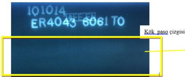
Şekil 3. B numunesindeki kök paso film görünümü
