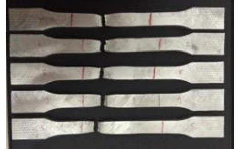
Şekil 6. Çekme deney sonrası A tipi numunelerinin görüntüleri
