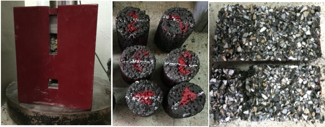
Şekil 3. Yarmada-çekme dayanımı deneyinin yapılışı.
