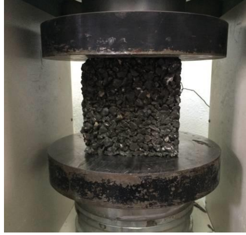
Şekil 2. Basınç dayanımı deneyinin yapılışı.
