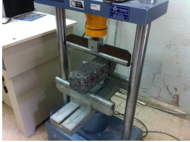
Şekil 4. Eğilme dayanımı deneyinin yapılışı.
