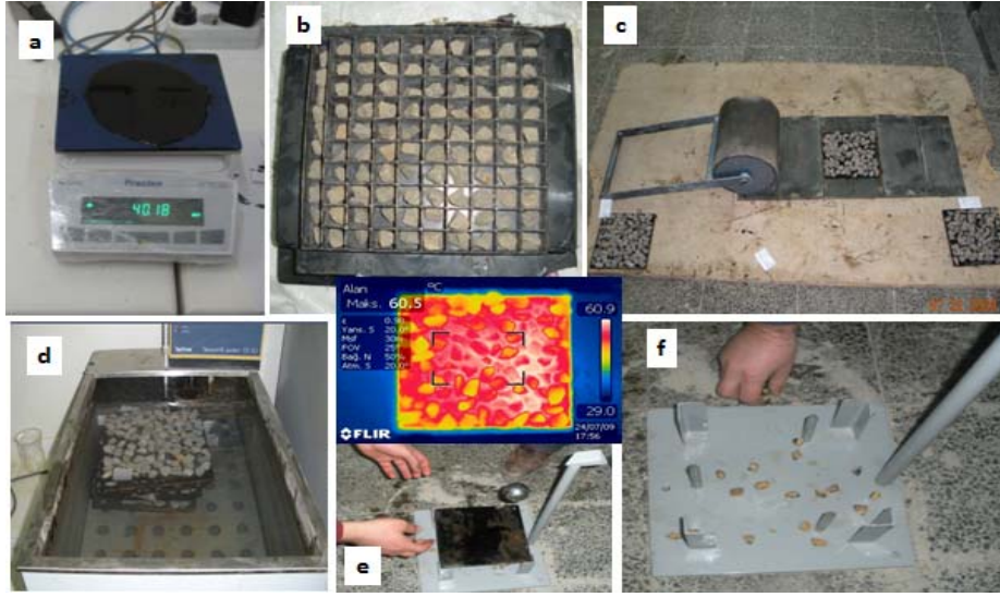
Şekil 1. Vialit yapışma deneyi aşamaları (a) sıcak plaka üzerine bitüm serilmesi, (b) mekanik sericiye yerleştirilmiş agrega numuneleri, (c) silindirleme, (d) su banyosunda bekletilen numuneler, (e) numuneler üzerine bilye düşürülmesi, (f) plakadan düşen agrega daneleri
