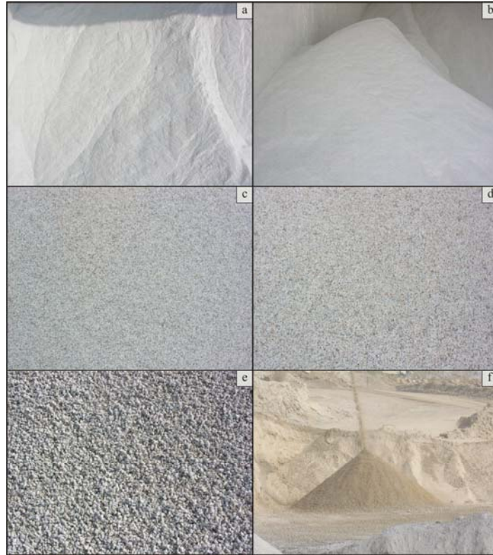
Şekil 6. İscehisar bölgesinde artık mermerlerden yapılan ürün çeşitleri (a) Mikronize kalsit (Toz); (b) İrmik; (c) Pirinç; (d) 1 Numara Mozaik; (e) 2 Numara Mozaik; (f) By Pass (Toprak).
