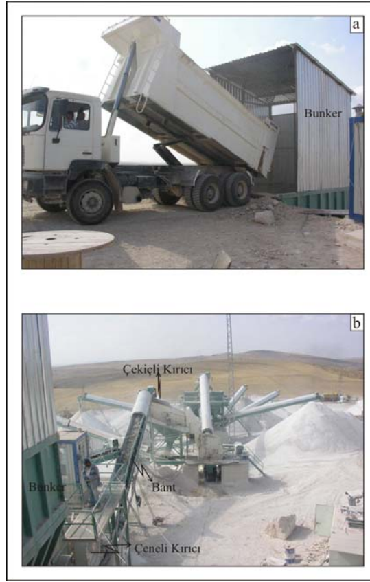
Şekil 5. (a)Artık mermerlerin Bunkere dökümü, (b) Bunker'e dökülen malzemenin çeneli kırıcıda kırılması ve elek yardımıyla çekiçli kırıcıya taşınması.
