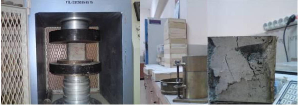
Őekil 2. Basınç dayanımı test sonrası numunenin durumu
