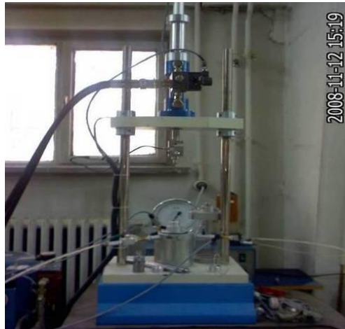
Şekil 4. Devirsel Üç Eksenli Deney Düzeneği
