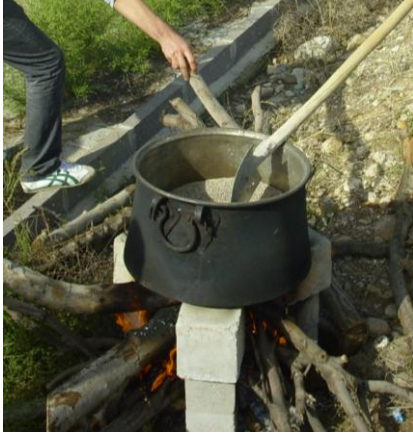
Şekil 1. PE 'lerin eritilmesi
