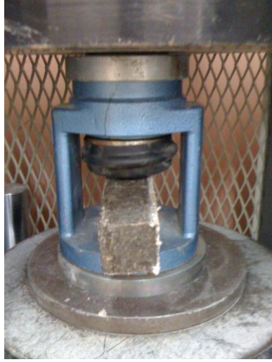
Şekil 5. Basınç dayanımı testi
