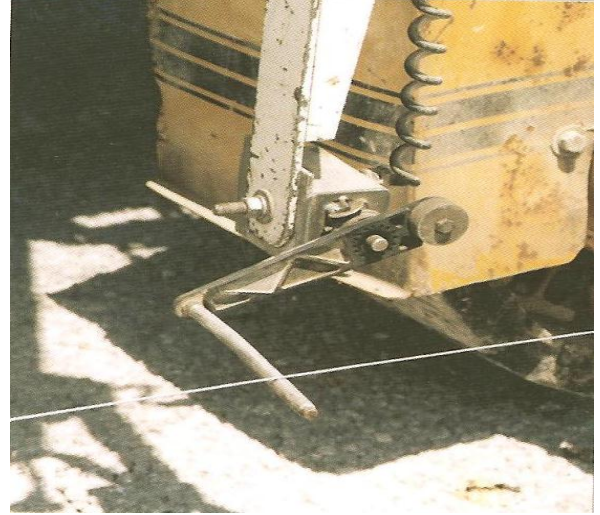
Őekil 4. Algılayıcı kılavuz telinin ayarlanması
