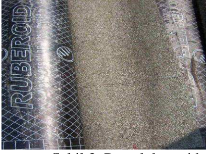
Şekil 3. Pamuk keçesi halindeki organik asıllı izolasyon malzemesi
