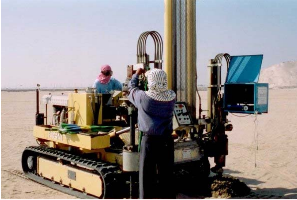
Şekil 5. Koni Penetrasyon Aletinin Taşınması ve Ankrajlarla Zemine Sabitlenmesi
