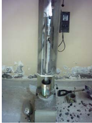
Şekil 2.3. Kompaksiyon aleti ve numunelerin sıkıştırılması
