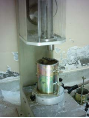
Şekil 2.3. Kompaksiyon aleti ve numunelerin sıkıştırılması
