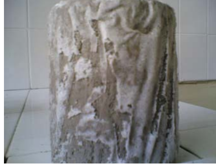
Şekil 2.1 Deney öncesi kalıptan alınan numune Şekil 2.2 -20°C’ de donduktan sonraki görünüm.
