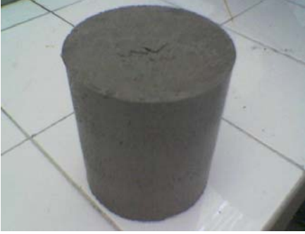
Şekil 2.1 Deney öncesi kalıptan alınan numune Şekil 2.2 -20°C’ de donduktan sonraki görünüm.
