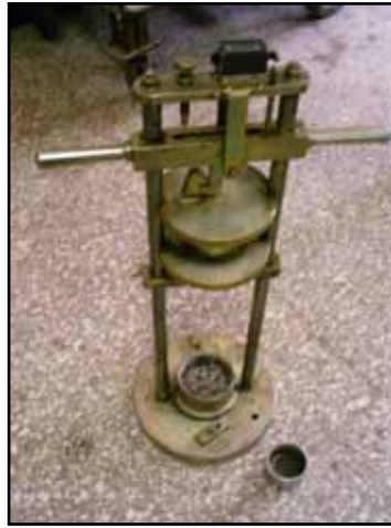
Şekil 4 Agregada Darbelenme Değeri Tayini için Deney Cihazı.
