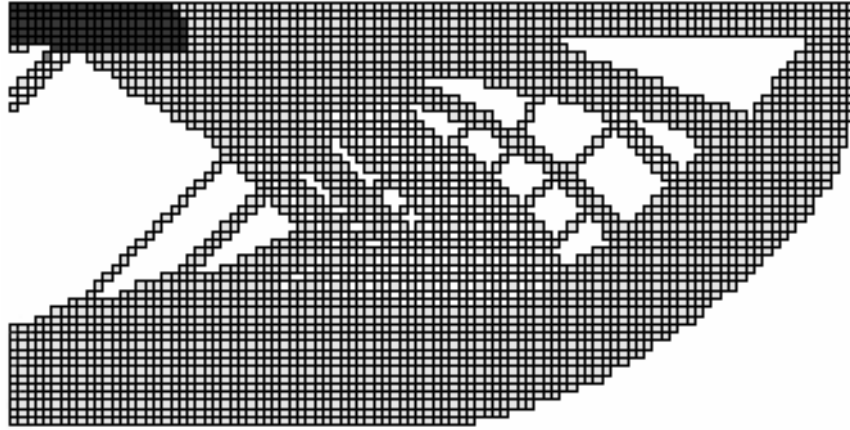
Şekil 15. 150. adımdaki kiriş topolojisi
