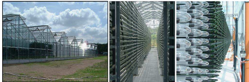
Şekil 3. Üst düzey kapalı biyoreaktör sistemi (Klötze, Wolfsburg, Almanya)
