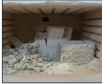
Şekil 6. 1000 °C sonrası dağılan numune örneği
