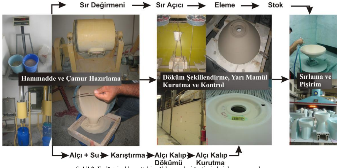
Şekil 2. Endüstriyel boyuttaki sağlık gereçleri üretiminde izlenen aşamalar
