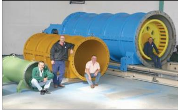
Şekil 1. Birincil öğütme ve çok ince öğütme uygulamaları için M_{1000} , M_{3000} ve M_{10.000} Isamill modelleri [22].
